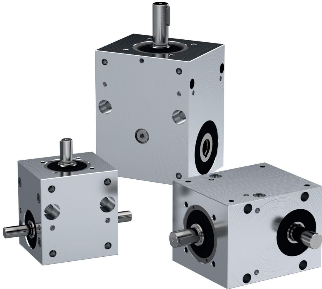
Die Getriebereihe NA "NEFF Aufsteckgetriebe" sind Kegelradgetriebe zur Umlenkung und Verteilung der Antriebsmomente bei Hubsystemen. Sie umfassen insgesamt vier Baugrößen und wurden kompatibel zu den kompakten kubischen Spindelhubgetrieben der M-Serie gestaltet. Die Kegelradgetriebe können entweder mit Hohlwelle zum direkten Anbau an die Hubgetriebe oder auf Wunsch mit einer Steckwelle zum Einsatz als Verteilergetriebe verwendet werden.
