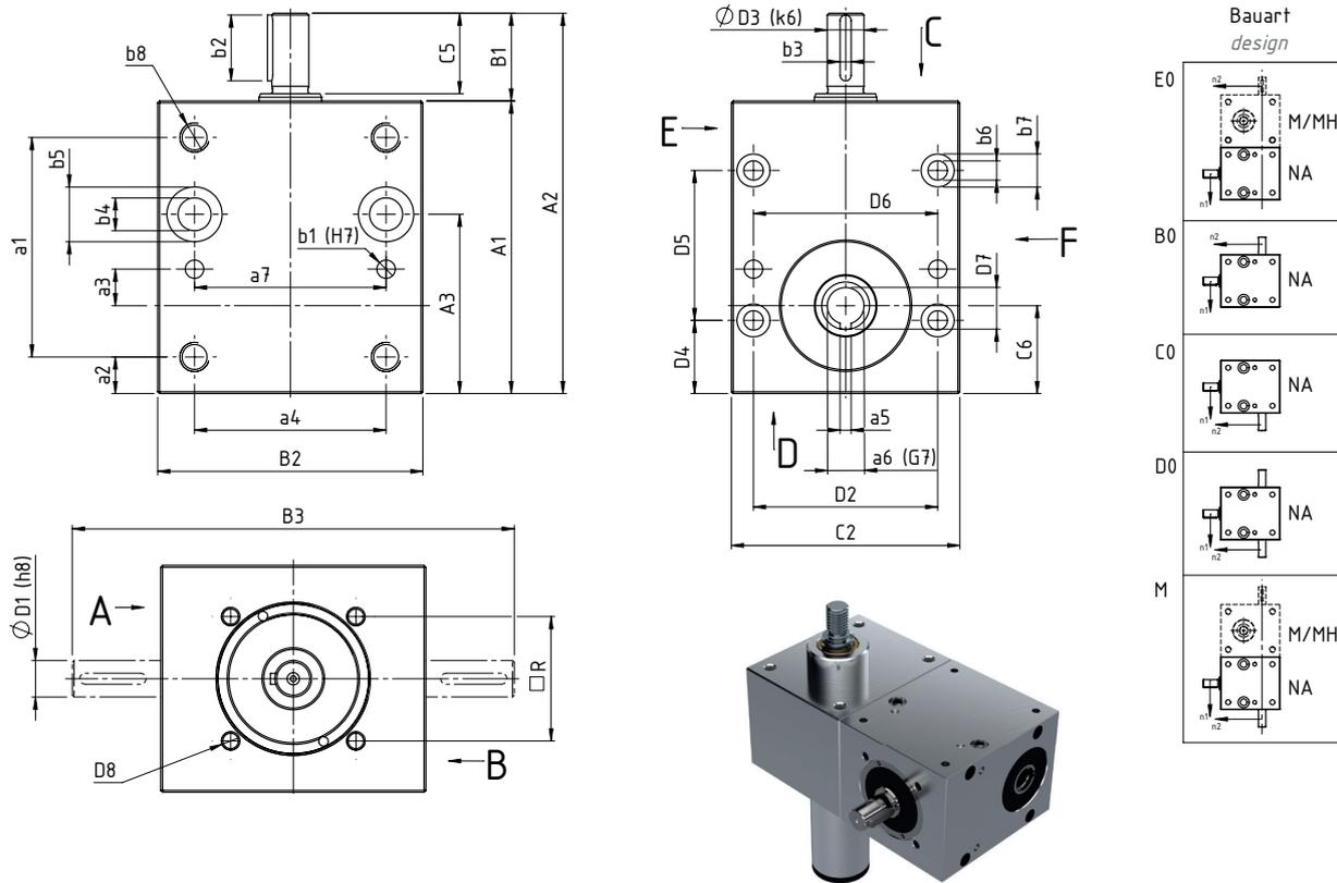
Bei den Ziffern A und B ist die Anbindung an Spindelhubgetriebe der M/J und MH/JH-Serie möglich.
